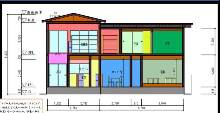
入口から入ってすぐの天井を吹き抜けにすることで、中層を開放的に採光し広く見せる様になっている。また、2階が全面窓となっているため、外部に取り入れた日光が吹き抜けを通じて1階まで届くよう設計されている。
